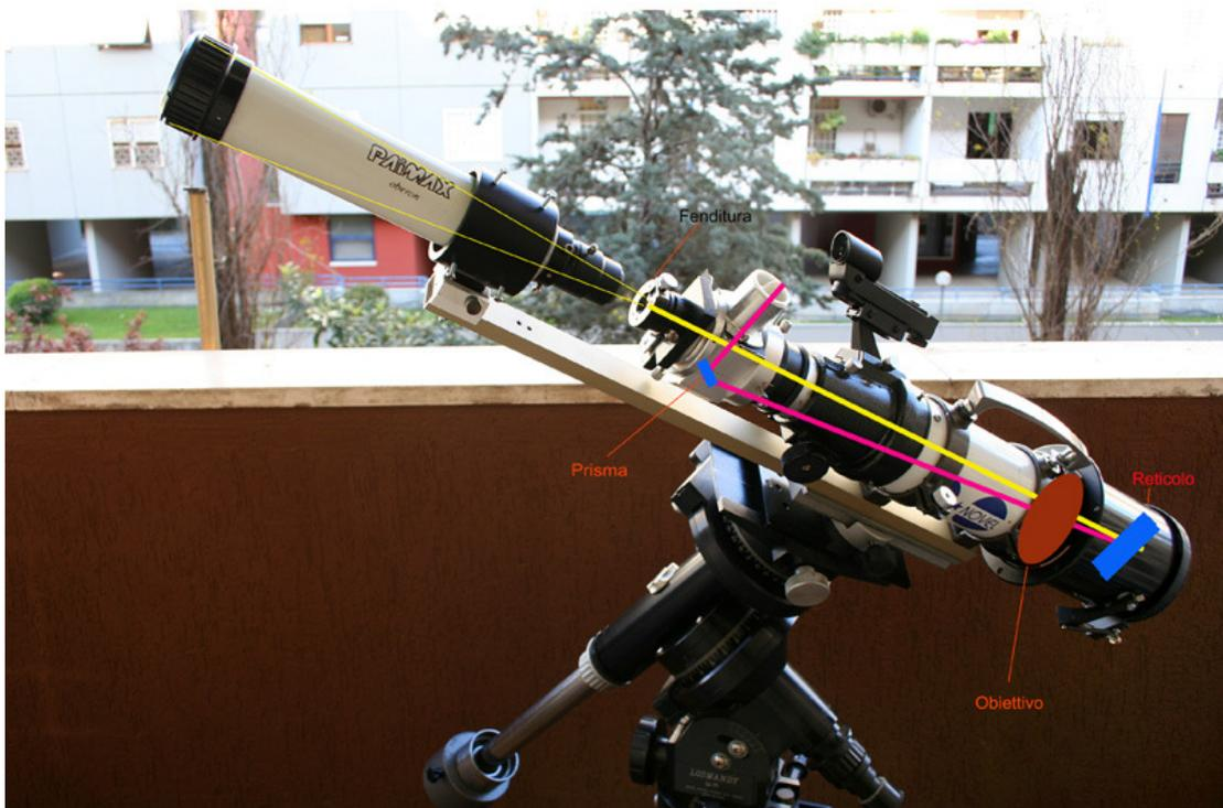
Un esempio di utilizzo di uno spettroscopio in modalità spettroelioscopio qui descritta è quello dello strumento POSS (POrtable Solar Spectrohelioscope).
