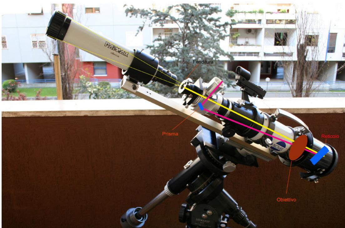
Un altro schema praticamente identico al precedente, soltanto molto più portatile (4 Kg x 95 cm di lunghezza, equivalente per dimensioni e peso ad un rifrattore da 10 cm) realizzato da chi scrive col nome di POSS (PORTABLE Solar Spectrohelioscope) Lo strumento sarà prevalentemente usato come spettroelioscopio portatile
