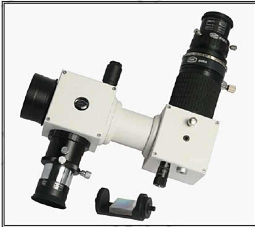
Dallo schema dello strumento si osserva che la luce in arrivo dal telescopio sulla fenditura viene parzialmente deviata da un prisma verso un portaoculare dove può essere alloggiato un oculare per la centratura dell'oggetto sulla fenditura stessa e la eventuale guida. Il collimatore, foccheggiato sulla fenditura, invia il fascio ottico al reticolo, dal quale l'immagine spettrale diffratta viene poi inviata all'ottica di osservazione.
